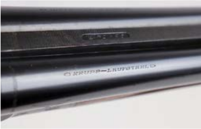
Ein Büchsenmachermeister in Landsberg erklärte dem Forstanwärter, dass die Läufe seines Gewehrs aus gutem Krupp-Stahl gefertigt wurden und somit wesentlich druckfester waren als Damast-Läufe. (Archiv SL)
